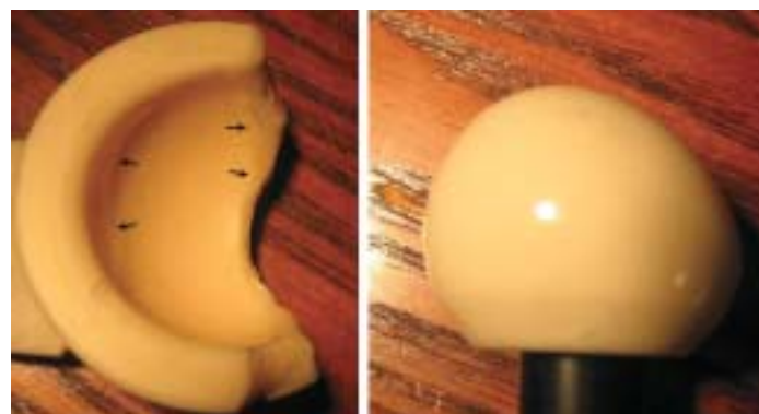
Figure 3 : Les dangers de la céramique d'alumine : la fracture d'implants.
