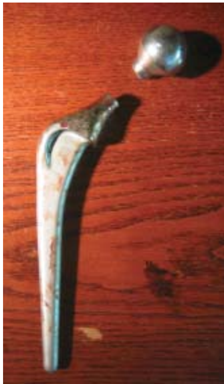
Figure 1 : Fracture de fatigue par corrosion d'une tige fémorale monobloc.
